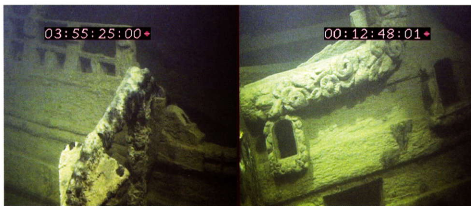
6 – Details van het Ghostwreck: links een boeganker, rechts en het hennegat (waar het roer naar buiten komt). De afwezigheid van de paalworm en het zuurstofarme water van de Oostzee zorgen er voor dat wrakken daar vaak goed bewaard blijven.
